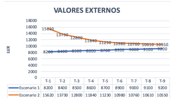
Fig. 10 Niveles de iluminación externo (lux) durante las mediciones de los dos escenarios en la fase 2.
