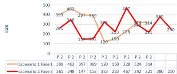
Fig. 15 Comparación de los niveles de iluminación en el eje A con las persianas abajo o cerradas para ambas fases (1 y 2).
