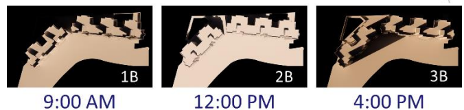
Figura 8. Análisis de soleamiento y sombra en conjunto residencial P.H. Pine Hills, se muestra el solsticio de verano en la fila superior y el solsticio de invierno en la inferior.
