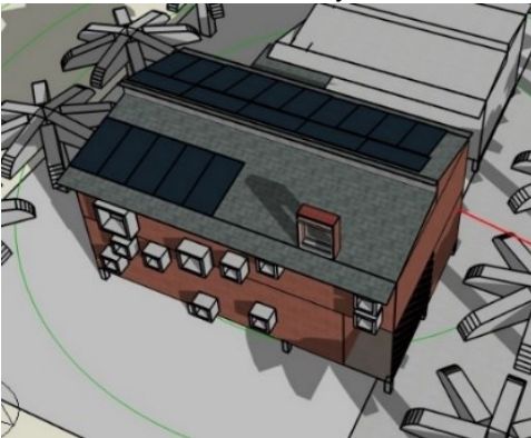
Figura 6. Sistema fotovoltaico dimensionado con el método dinámico.
