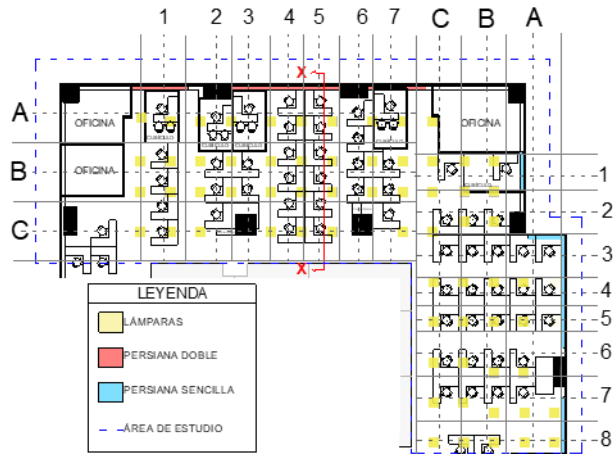
Fig. 4 Planta de iluminación y mobiliario del sector estudiado del piso 6 mostrando los tipos de persianas y su respectiva localización (fase 1, antes de la reforma).
