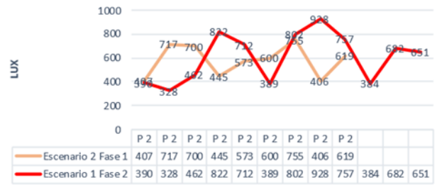
Fig. 14 Comparación de los niveles de iluminación en el eje A con las persianas abiertas para ambas fases (1 y 2).
