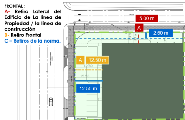
Fig. 4 Distancias de retiros Edificio F&F Tower.
