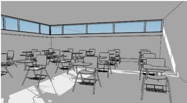
Figura 4. Simulación de iluminación en la misma posición de la cámara PC1 dentro del Salón 211 a las 8:00am.
