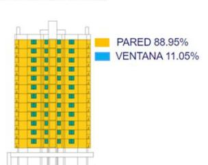
**Figura 5.** Elevación frontal y posterior (izquierda) y elevaciones laterales (derecha) de una torre del conjunto Torres de España, el color amarillo representa las paredes y el turquesa las ventanas.
