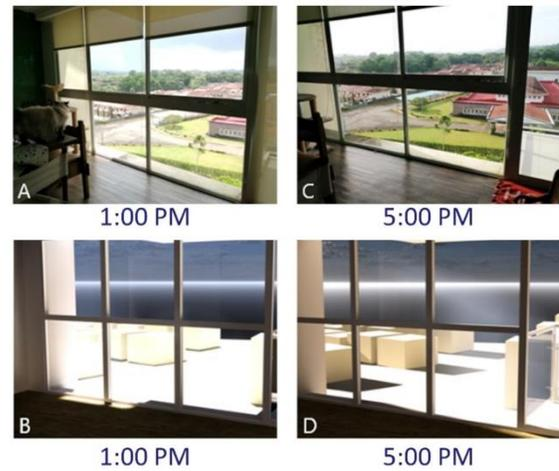
**Figura 10.** Análisis de sombras de la sala comedor del Apto.4 A del conjunto P.H Pine Hills, se muestra imágenes de las sombras reales en la fila superior (15 de julio de 2021) y la simulación en la parte inferior.
