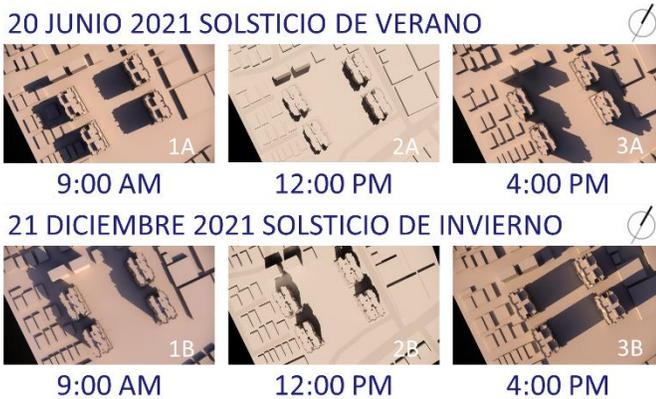
**Figura 9.** Análisis de soleamiento y sombra en conjunto P.H. Torres de España, donde se muestra el solsticio de verano en la fila superior y el solsticio de invierno en la inferior.
