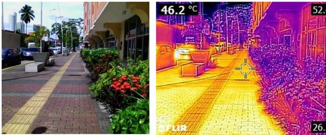
Figura 15. Medición de temperatura superficial del sector B.1
