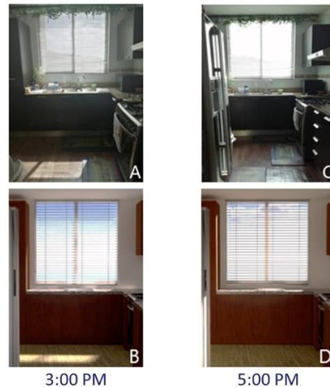
**Figura 11.** Análisis de sombras de la cocina del Apto.4 A del conjunto P.H Pine Hills, se muestra imágenes de las sombras reales en la fila superior y la simulación en parte inferior.
