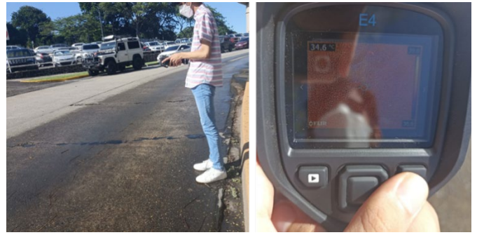
Figura 4. Proceso de medición de temperatura superficial en el Sector 2.
