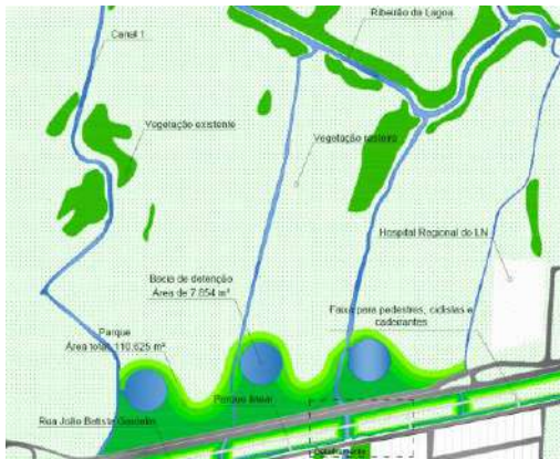
Figura 18: Pré-dimensionamento do parque e bacias de retenção (Elaborado pelo próprio autor, 2023).
