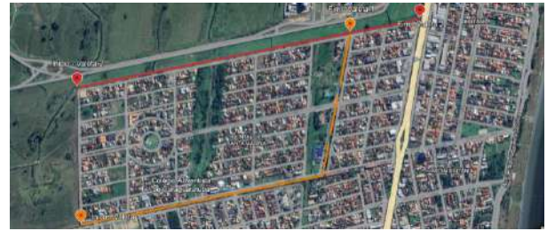
Figura 6: Traçado das valetas 01 e 02 que drenam o bairro (Adaptado de FUNDESPA “Relatório R6”, 2016).
