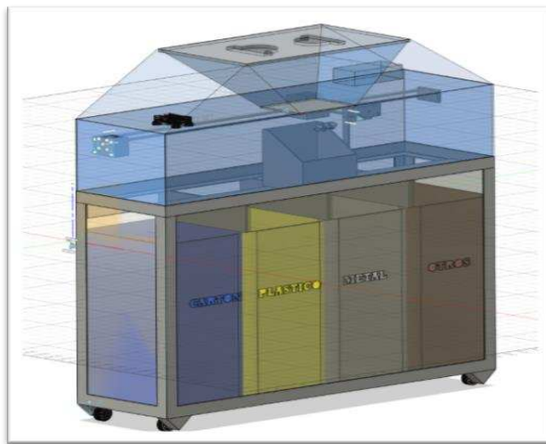
Figura No. 2. Diseño estructural del prototipo de cesto inteligente.
