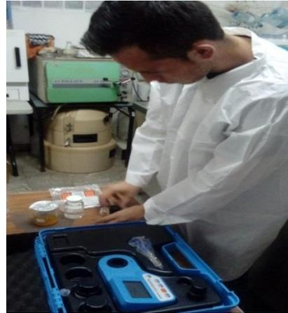
**Figura 2.** En la izquierda, toma de muestras de agua del sistema purificador y a la derecha, comprobación de la ausencia de cloro que no interfiriera con el ensayo.
