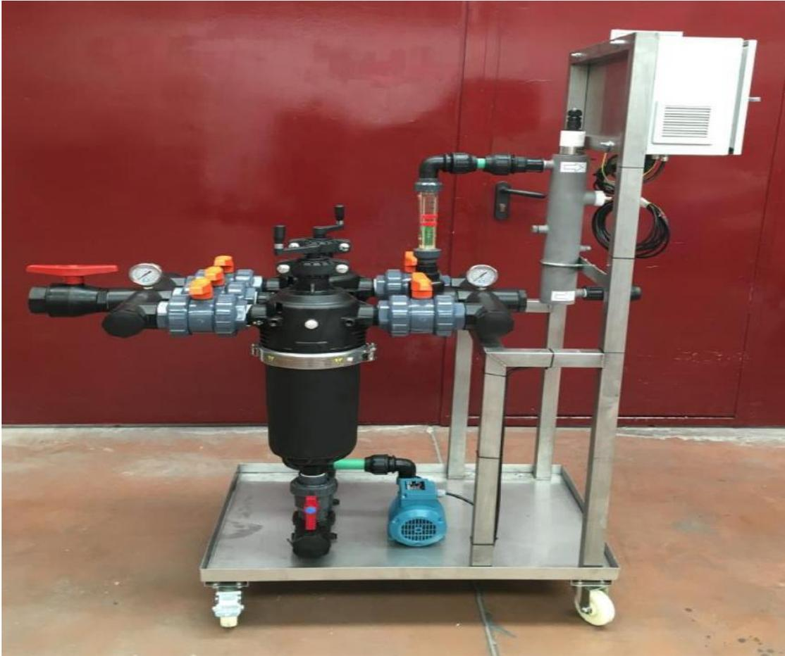
**Figura1.** Eco Reactor de Fotocatálisis UV/ TiO<sub>2</sub>, en la que se observa los sistema de filtro y el reactor donde se genera los radicales libres.
