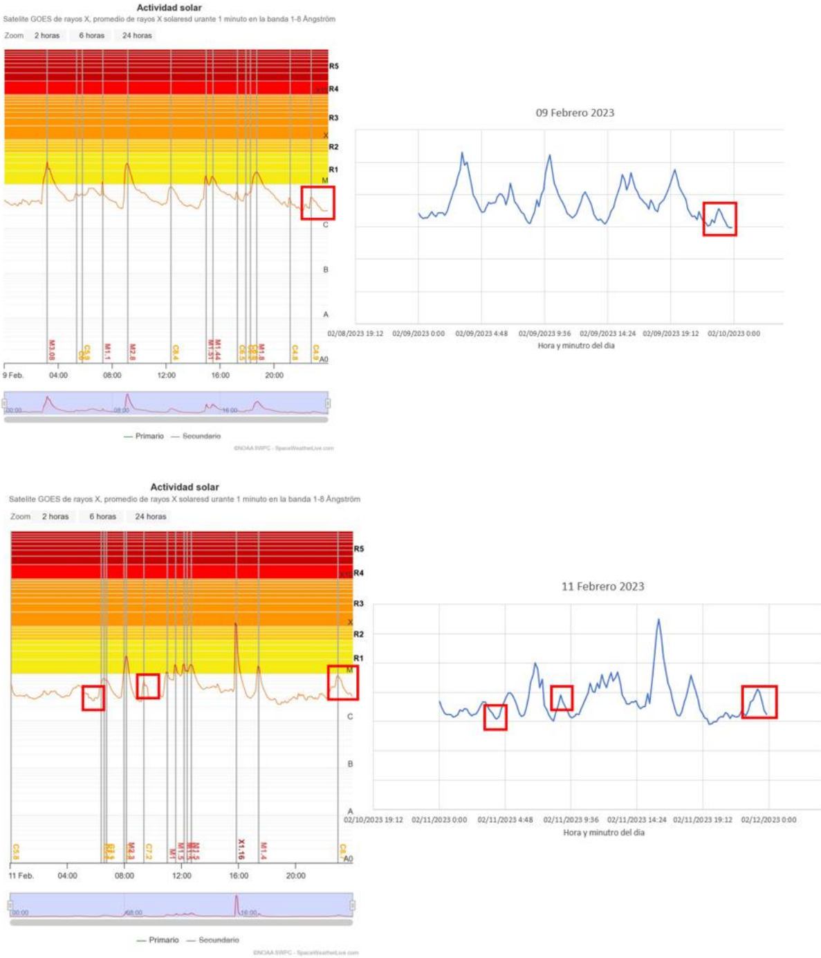
Figura 6b: Eventos de Llamadas Solares proporcionado por el sitio SoHo (Izquierda) y los capturados por la unidad de recepción VLF desarrollada (derecha) del 9 y 11 de febrero de 2023 respectivamente.
