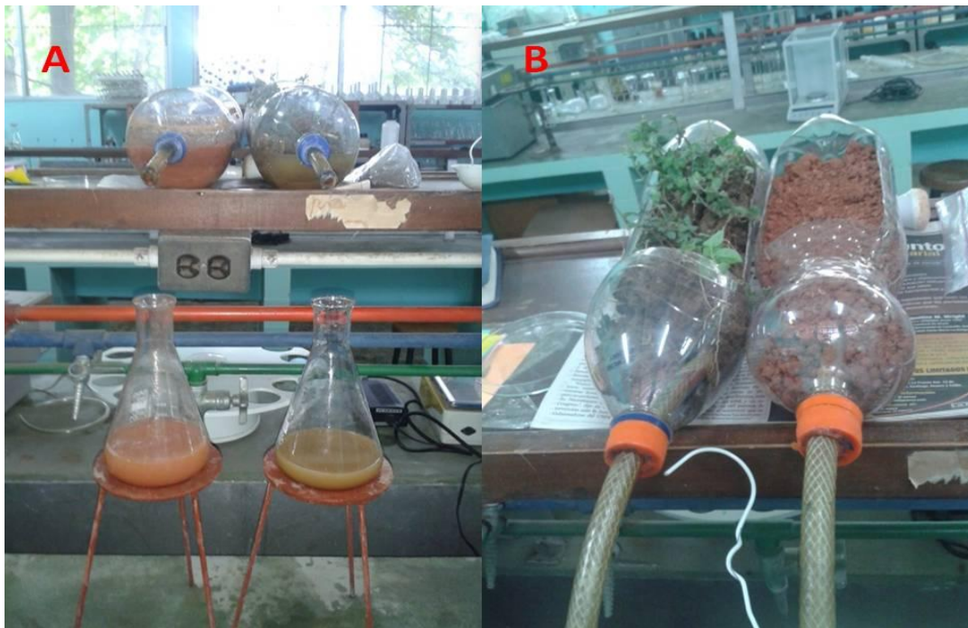
Figura 1. Sistema elaborado para medir la escorrentía de los suelos erosionados y con vegetación.
