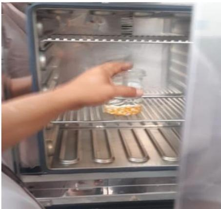
**Figura 1.** Hidratación del maíz para la extracción del almidón
