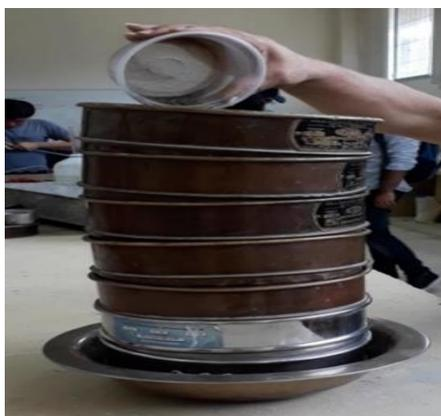
**Figura 7.** Tamizado de la tierra con el bioplástico
