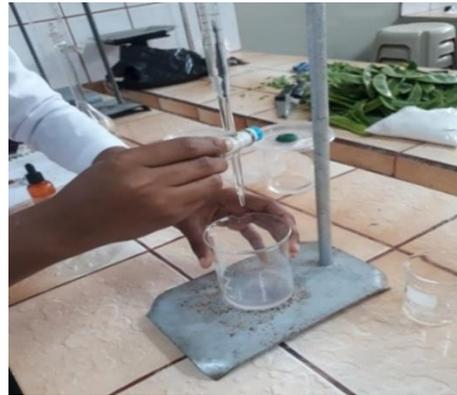
**Figura 6.** Titulación del  $\text{Ba}(\text{OH})_2$  con el  $\text{HCl}$  remanente
