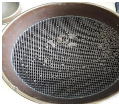
**Figura 8.** Restos de bioplástico luego de la prueba de biodegradabilidad
