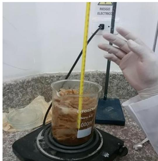
**Figura 4.** Digestor usado experimentalmente
