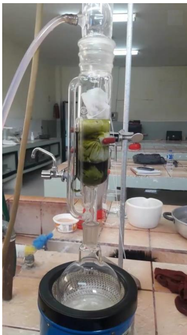
Figura 4. Montaje empleado en la destilación con Soxhlet
