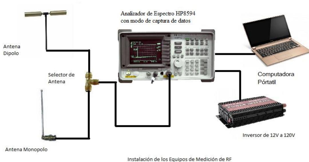
**Figura 1: *Instalación de los equipos para la realización de la captura de los datos.***
