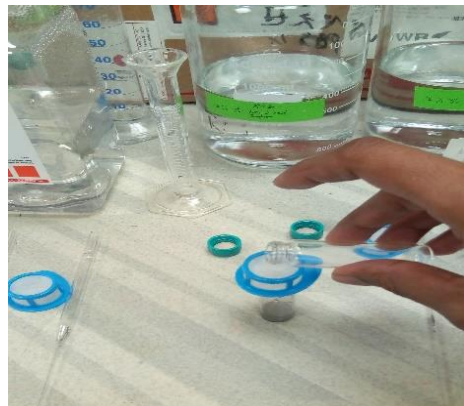
Figura 9: Filtración de las partículas/microtransportadores de titanio.
