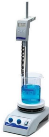
Figura 11: Plato caliente para hacer el tratamiento térmico en las partículas
