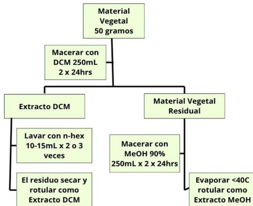
Nota: Representación del protocolo de extracción del material vegetal utilizando diclorometano (DCM) y metanol al 90% (MeOH).
