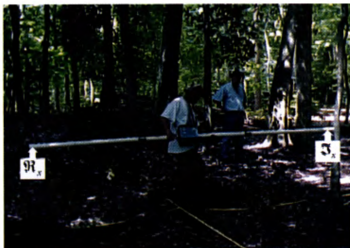
Fig. 2. Dispositivo EM31 de la familia Slingram.
