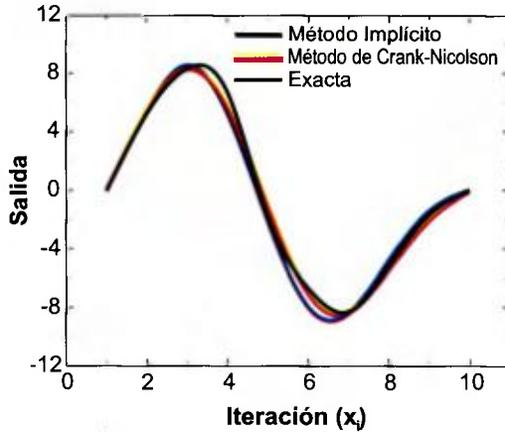
Fig. 4. Gráfico que muestra el comportamiento de la solución numérica con la exacta dada por la Ec.(5), obtenidas tanto por el MI, como por el MCN, para la situación en que,  $t_{\max} = 0,0010s$ , manteniendo  $k$  y  $a_n$  constantes.
