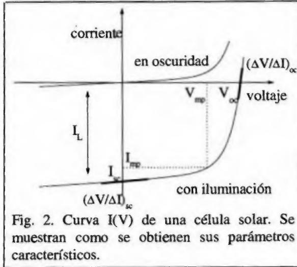
Fig. 2. Curva I(V) de una célula solar. Se muestran como se obtienen sus parámetros característicos.
