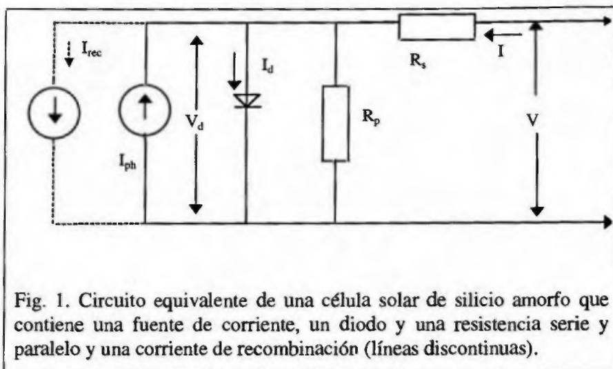
Fig. 1. Circuito equivalente de una célula solar de silicio amorfo que contiene una fuente de corriente, un diodo y una resistencia serie y paralelo y una corriente de recombinación (líneas discontinuas).
