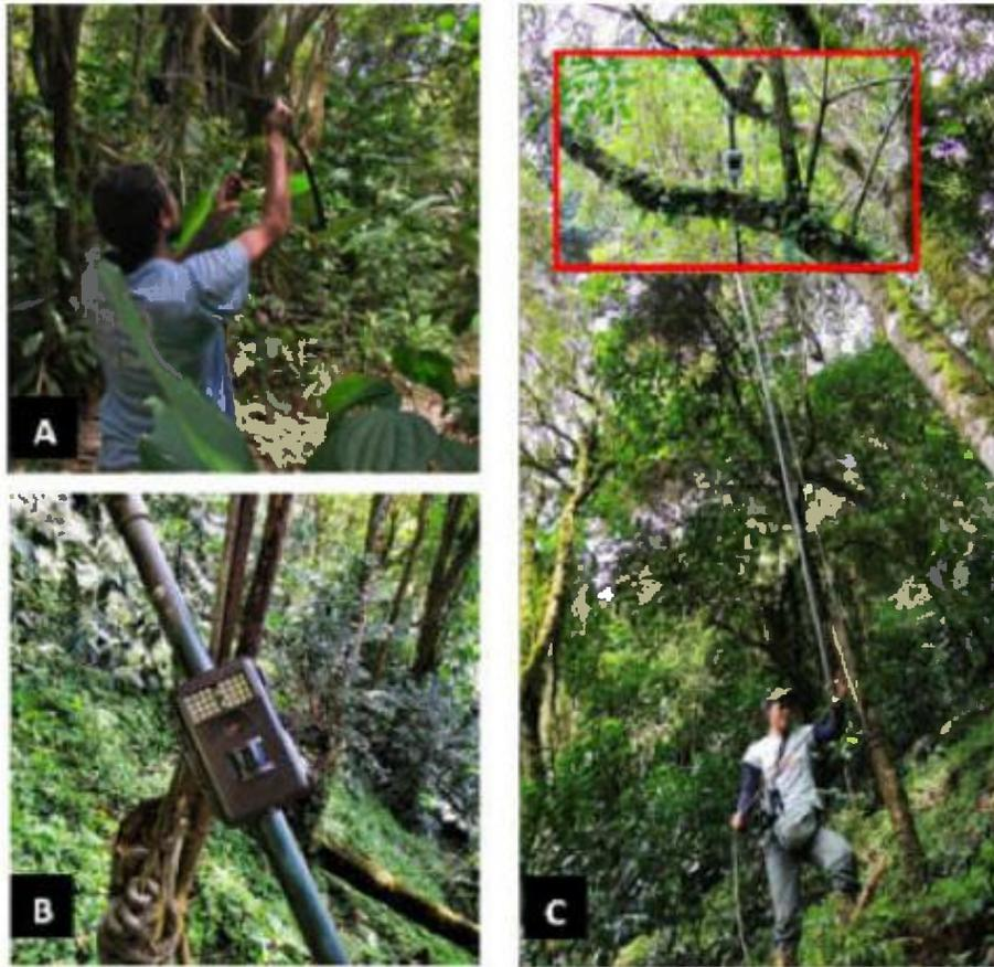
**Fig. 2** Para aplicar el SCO A) se dirige una cuerda hacia una rama, utilizando un arco, B) se ata la cámara a un tubo de PVC y C) se unen tantos tubos sean necesarios para alcanzar la altura deseada.
