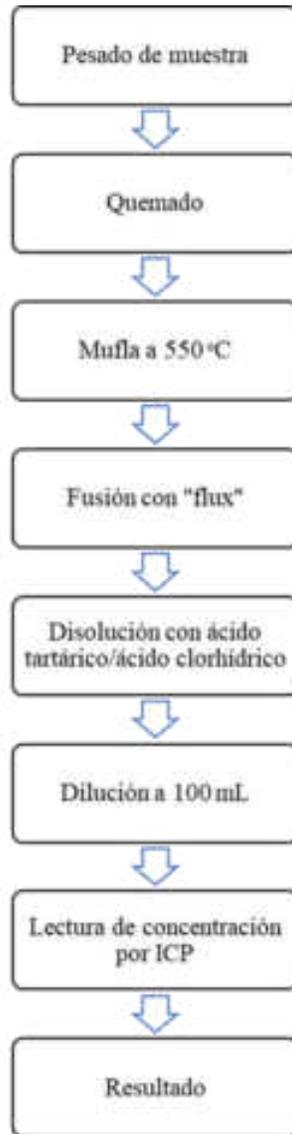
**Fig. 1.** Esquema de procedimiento del método IP 501.
